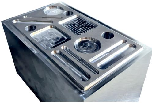
Ein für die Forschung am IFW zur Datenakquise gefertigtes Analogiebauteil mit Standard-Formelementen © IFW
